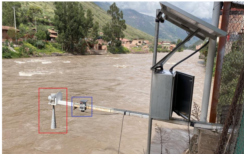
Figura 2: En color Azul el sensor LIDAR en rojo de la EPH sobre el río Vilcanota en Pisac.
