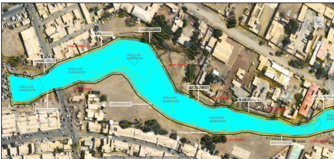
Según la Autoridad Nacional del Agua (2017), la gráfica que se muestra, se puede identificar los tramos en los que la huella de inundación afecta a los límites de construcciones y terrenos de la zona urbana, mediante la distancia mínima indica para la faja marginal y para zonas urbanas (5 metros).
