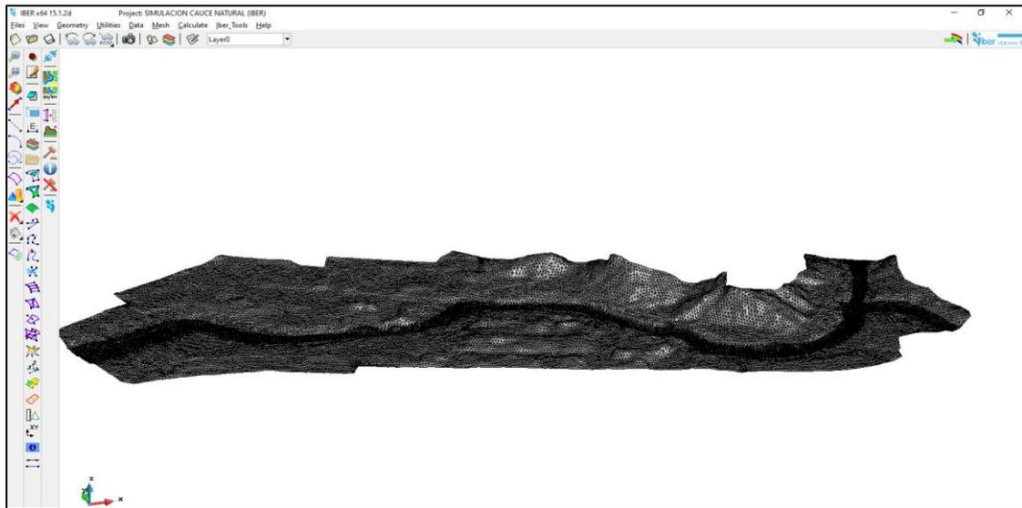
Utilizando la malla generada en el modelo, se incorporaron las elevaciones del Modelo Digital del Terreno (MDT) en Iber. De este modo, se logró obtener una superficie con un mallado específico diseñado para la simulación del caudal (ver figura 60).
