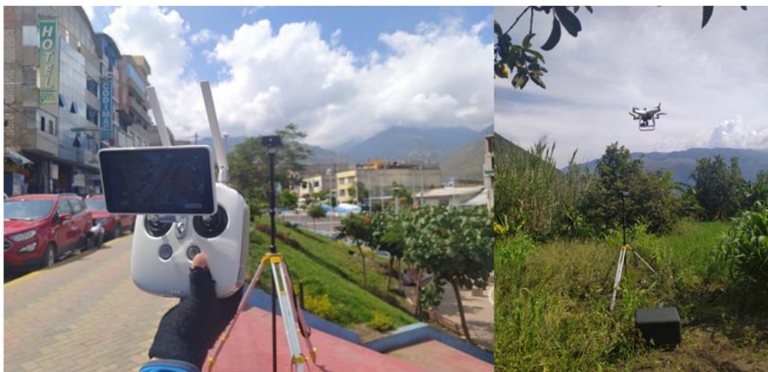
Figura 52 — Estación diferencial en diferentes puntos del plan de vuelo
