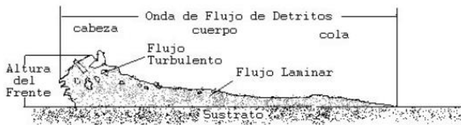
Figura 13 — Perfil de un frente típico para un flujo de detritos
