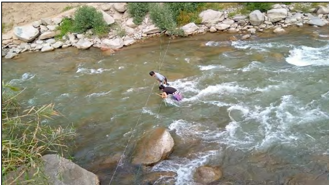
Figura 4.7. Midiendo la profundidad cada 1 m sobre el nivel del cordel - Transecto N° 3.
