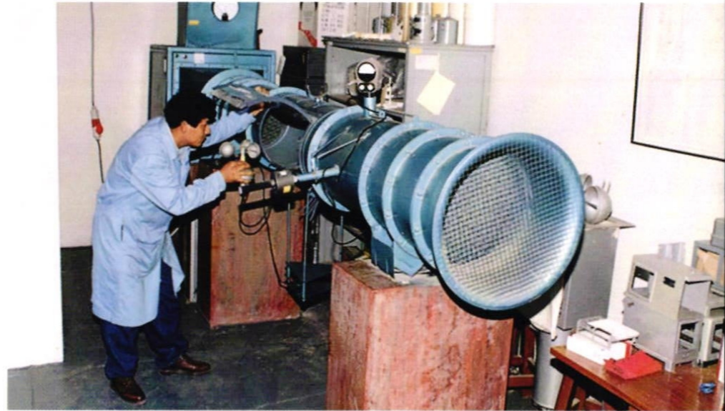
▲ En la foto se aprecia el Túnel de Viento donde se realizan diversas pruebas al instrumental de medición de este importante parámetro meteorológico
