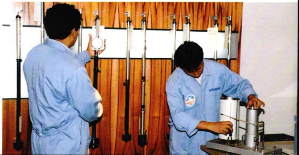
▼ Apreciamos el Gabinete de Barometría donde se realizan las pruebas y calibraciones de barómetros y altímetros, prestando un especial apoyo al sector aeronáutico y a diversas instituciones afines.
