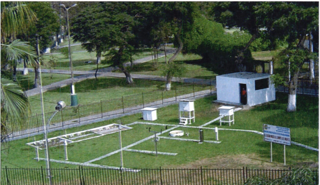
Estación Meteorológica de Campo de Marte (Lima-Perú): Se realizan observaciones meteorológicas como son: Temperatura, Humedad, Precipitación, Presión Atmosférica, Viento, Evaporación, Visibilidad, Horas de Sol, Radiación Solar, etc.
