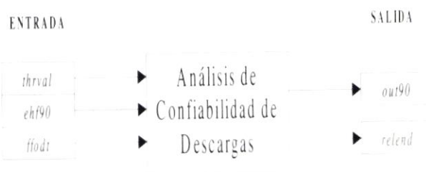
Figura 3. Archivos de entrada y salida requeridos para ejecutar el código para el Analisis de Confiabilidad de Descargas.
