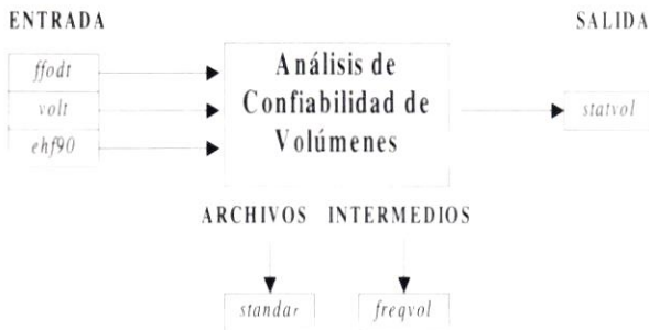
Figura 5. Archivos de entrada y salida requeridos para ejecutar el código para el Análisis de Confiabilidad de los Volúmenes.
