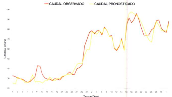
Figura 5. Caudales pronosticados del río Rímac del 31-01 al 02-02 del 2001.
