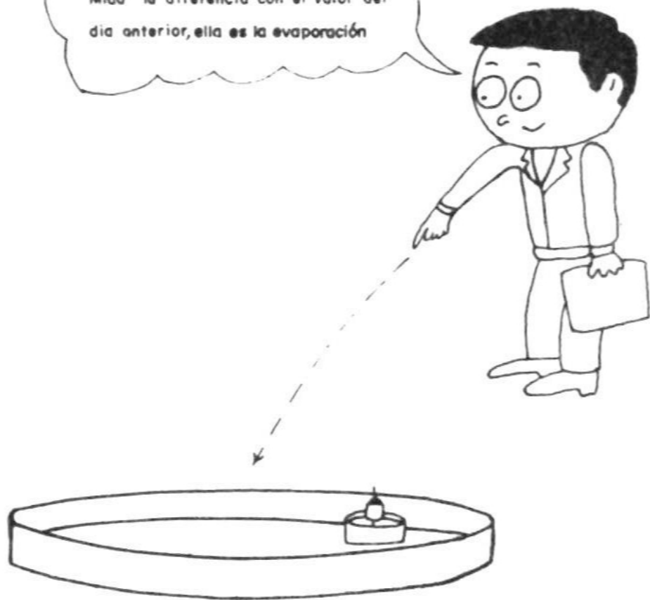
TANQUE DE EVAPORACION TIPO "A"
