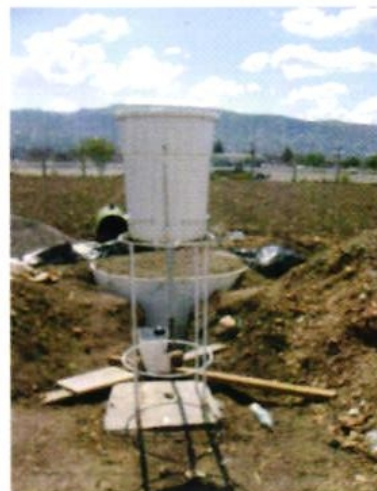
Lisímetro instalado, listo para llevar a capacidad de campo
