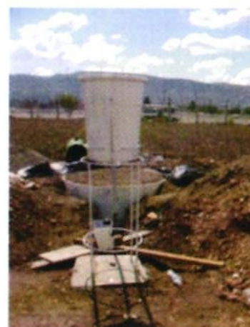
Lisímetro instalado, listo para llevar a capacidad de campo antes del trasplante de las plantas de aicachofa.
