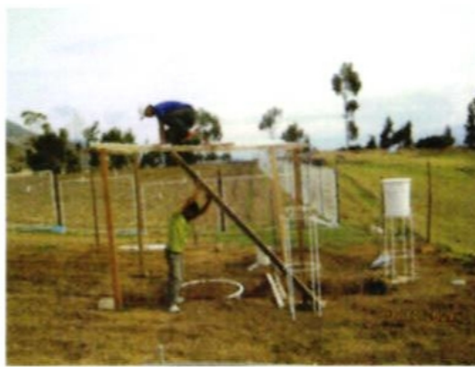
Lisímetro instalado, listo para llevar a capacidad de campo antes del trasplante de las plantas de alcachofa
