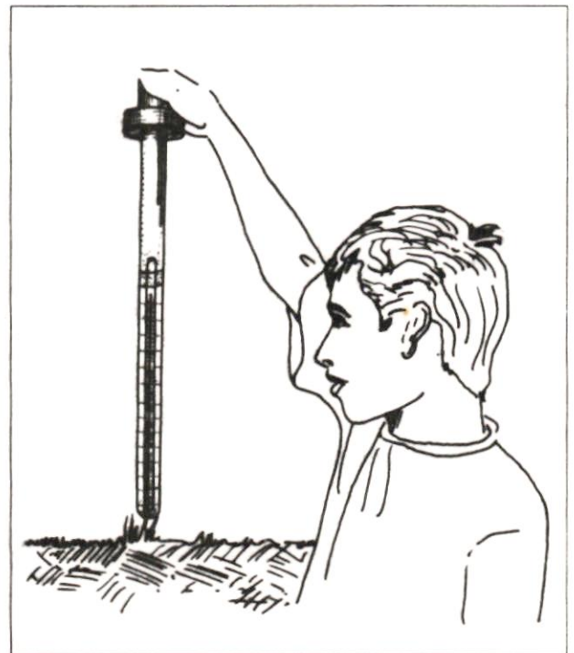
Fig. 45 Lectura Geotermómetro de 100 cm
