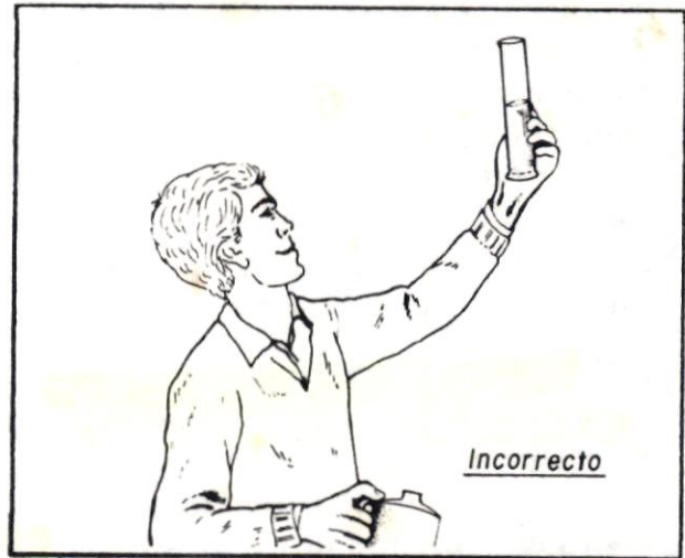
Fig. 14 Lectura incorrecta: error de paralaje
