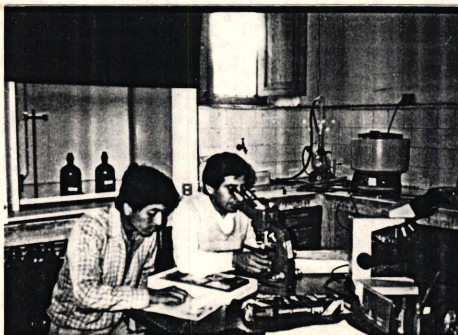
FOTOGRAFIA Nº 6 - Se muestra la forma como se ha llevado a cabo las mediciones y conteo de las gotas de agua de la niebla atrapada en la placa, a través de un microscópio en el Laboratorio del CIZA de la UNA La Molina.
