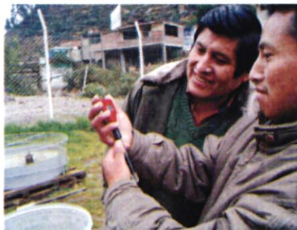
Figura N° 10, leyendo el pH de la muestra colectada.
