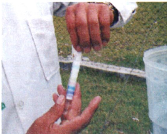
Figura N° 08, tira del papel indicador luego de haber sido remojado en la muestra recolectada.
