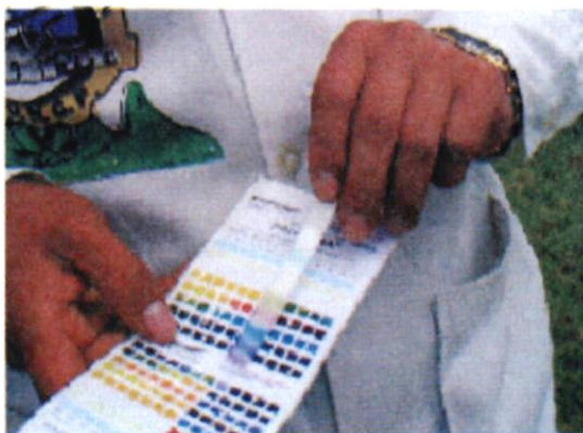
Figura N° 09, procediendo a efectuar la comparación entre la tira de papel indicador y el patrón, según el cambio de color obtenido.
