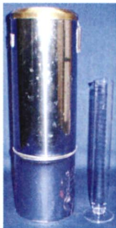
Figura N° 05, Partes del pluviómetro
