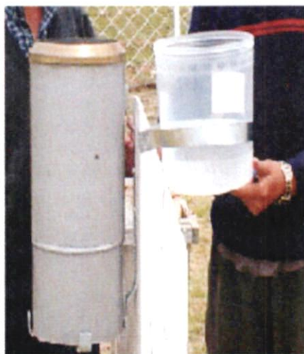
Figura N° 04, acoplamiento del colector junto al pluviómetro, según el protocolo de muestreo desarrollado por la REDDA.
