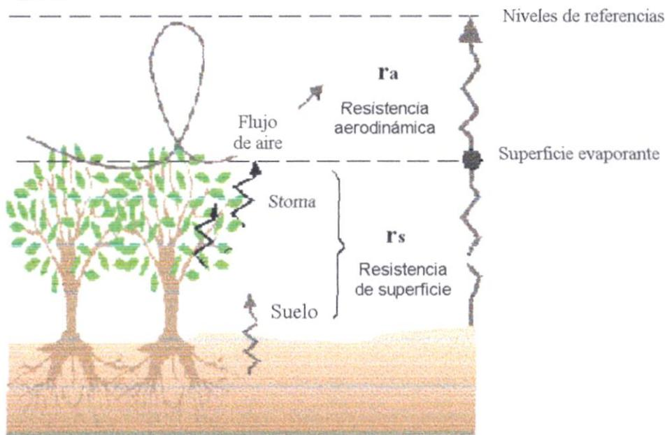
**Figura 2.11. Resistencia superficial y aerodinámica del flujo de vapor de agua**
