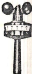
**ANEMOMETRO.-** Anemómetro de Mano se usa especialmente en expediciones e investigaciones de un lugar, por medio de la dirección y velocidad del viento en la superficie.
