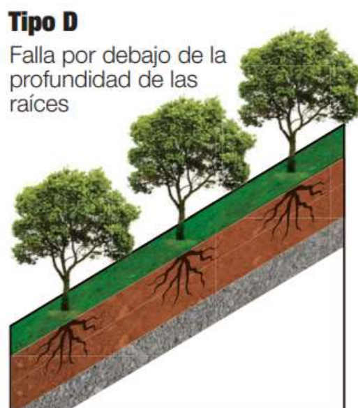
Figura 14-8.- Talud Tipo D.
