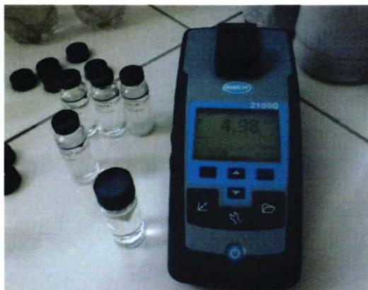
Foto 10: Turbidímetro portátil 2100 Q.
