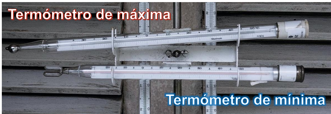
Figura 1. Termómetros de la temperatura máxima y mínima en una caseta meteorológica
