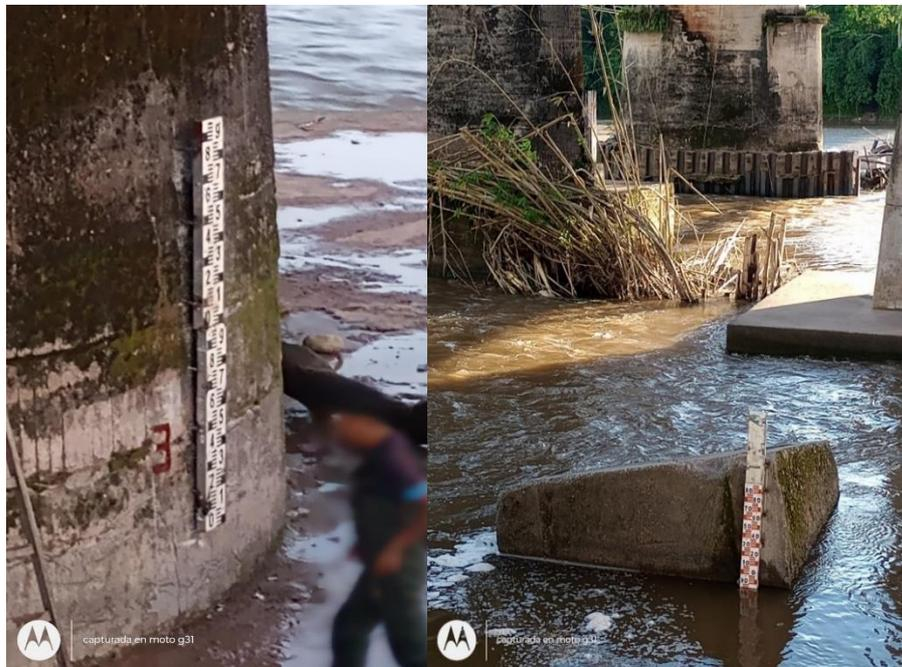
**Foto 20: HLM – Aguaytía instalación de reglas provisionales (regla 3 y 1), instaladas en el área de influencia para la continuidad en la toma de datos.**
