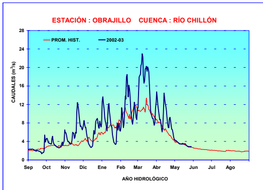
Figura 7 . Hidrograma del caudal medio diario del río Chillón
