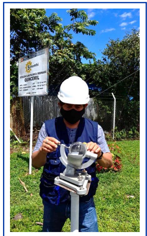
Figura 22. Medición de la radiación solar con un heliógrafo
