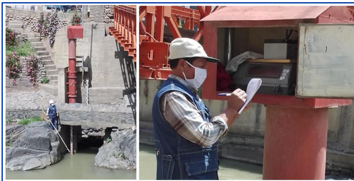
Figura 22. Medición del nivel del río Paucartambo y Registro de caseta limnigráfica
