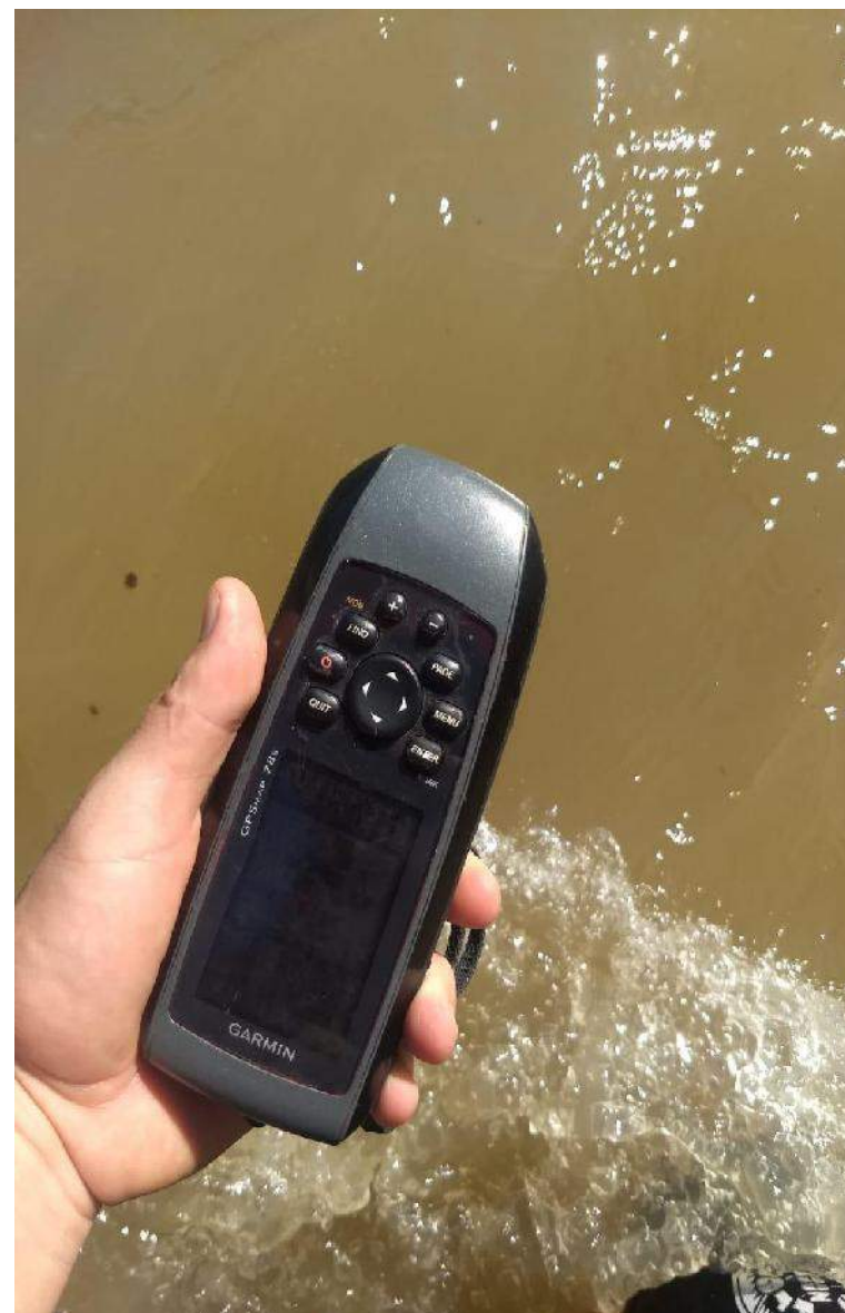
Fotografía 5. Utilización del GPS para obtener las coordenadas del punto de referencia.
