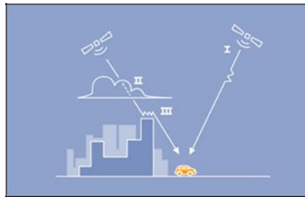
Figura 3-10 Errores en la ionosfera y Troposfera
