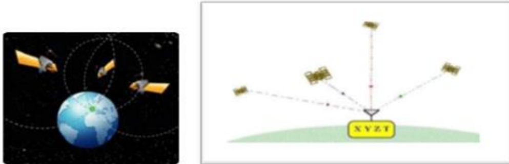
Figura 3-8 Determinando las coordenadas de un punto en la superficie terrestre
