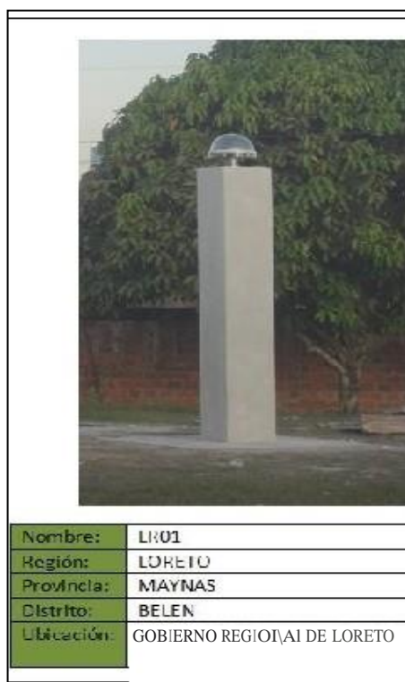
Figura 3-22 Antena GNSS de La Estación Permanente LR01
