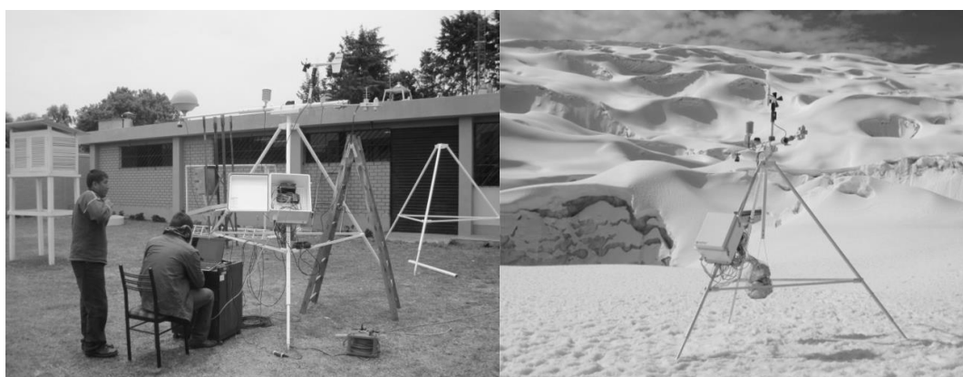
Figura. 2. (Izquierda) Ensayos de control de inclinación del soporte trípode de la estación climática a ser instalada en el Glaciar Quisoquipina. (Derecha) estación climática instalada en el glaciar Quisoquipina a 5180 metros en la Cordillera Vilcanota.
