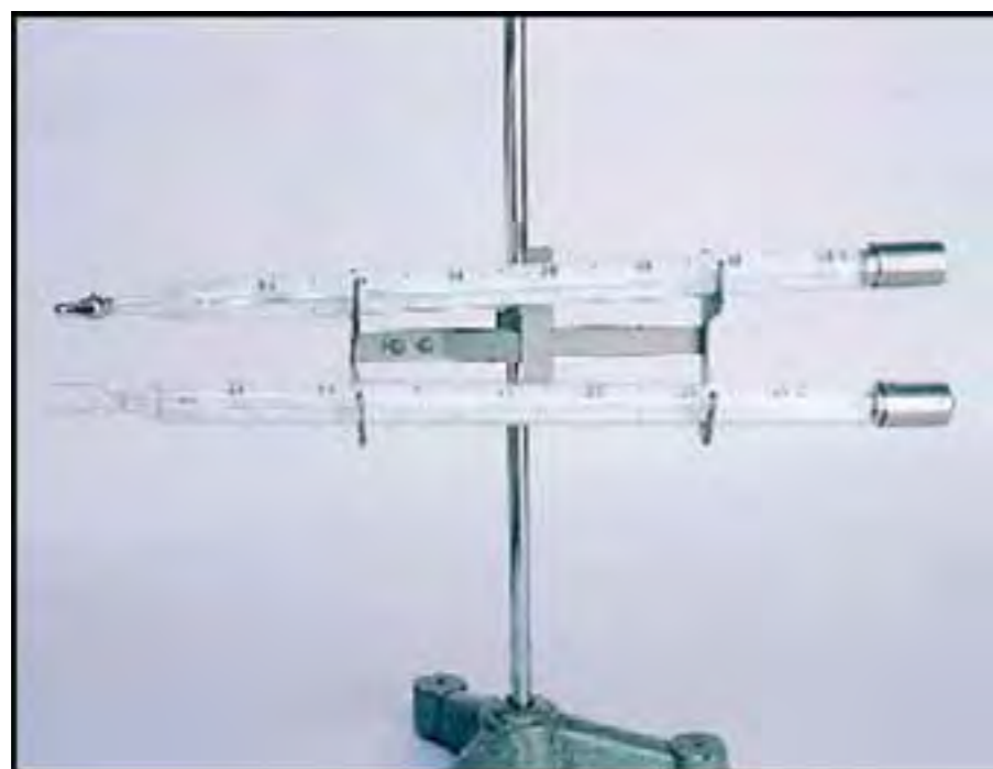
Fig. 2.1. Termómetros de máxima y de mínima: El termómetro inferior es el de mínima y se instala siempre en forma horizontal.
