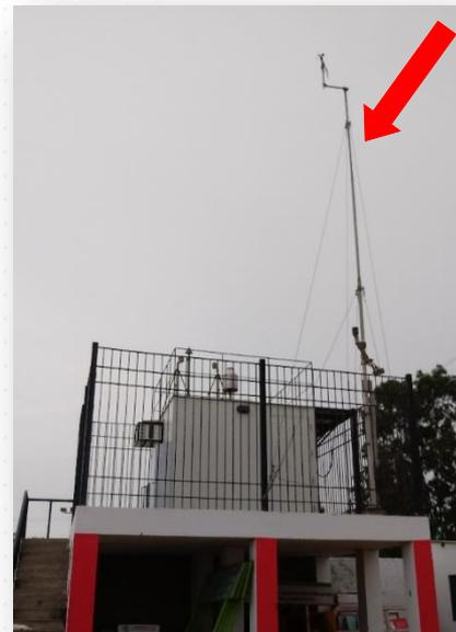
Dirección y velocidad de viento, temperatura, humedad relativa, RUV.
